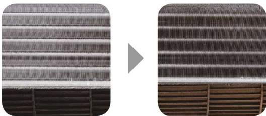
Sisäyksikön lämmönsiirrin 10 vuoden jälkeen ilman pinnoitusta.
